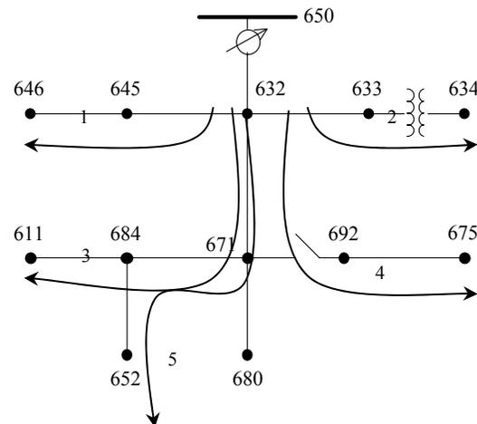
Fig 2. IEEE 13 Node Test Feeder<sup>[9]</sup>
